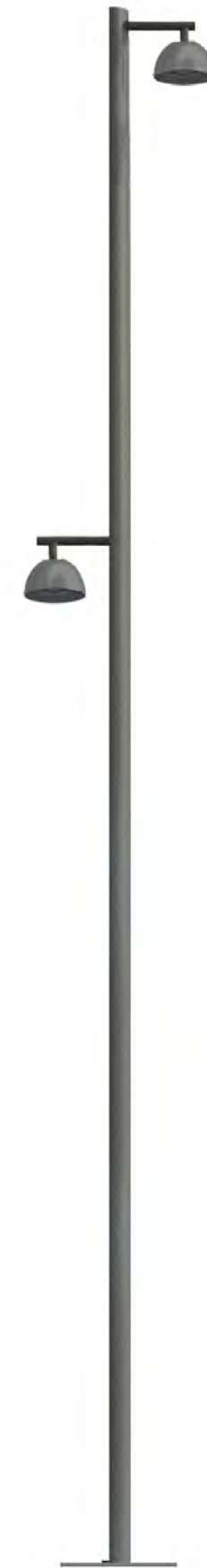
Luonnos katualueen valaisinkokonaisuudesta. Pylväs on suora, Ø 140 mm, ja valaisimet yksinkertaisen hillityt, esimerkiksi malli Copenhagen, valmistaja Philips.
