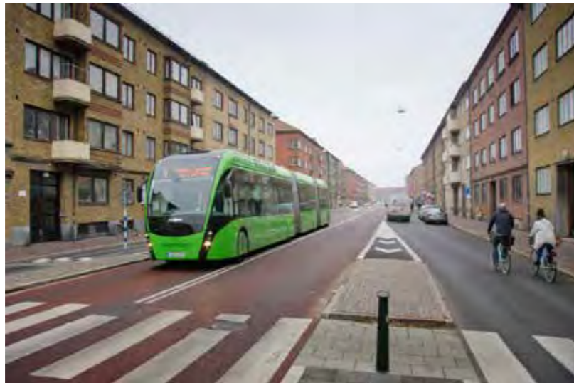
Kuva 94. Superbussin infrastruktuuri vastaa raitiotietä eli valtaosin superbussi kulkee omilla kaistoilla. Kuvassa 25-metrinen tuplanivelbussi Malmössä.
