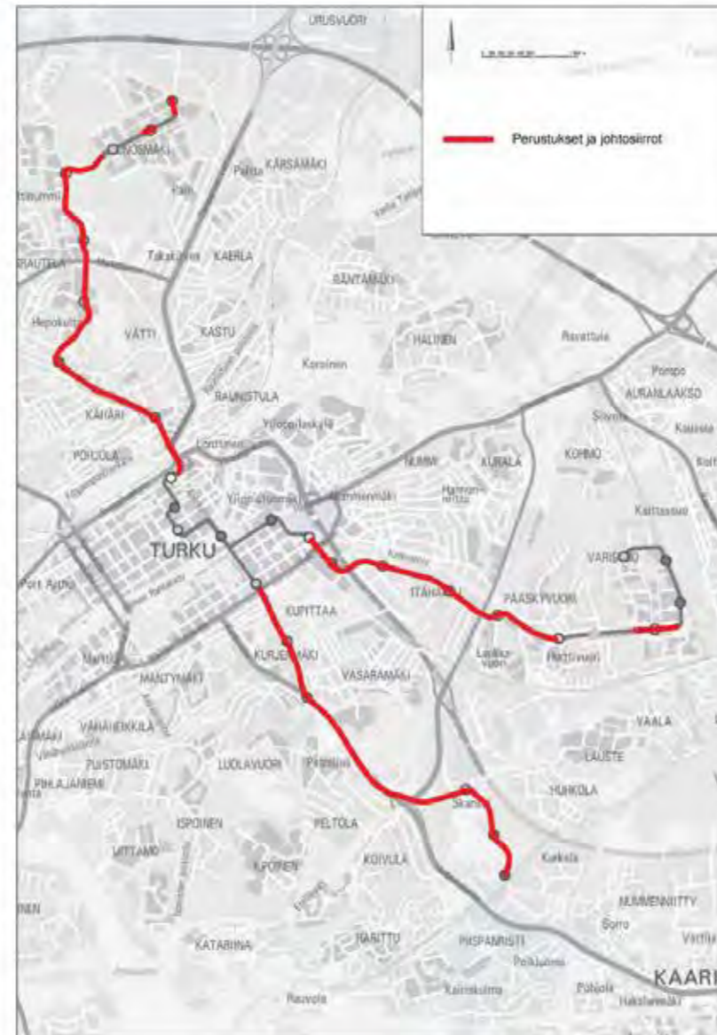
Kuva 96. Superbussin reittiosuudet, joissa poikkileikkaus muuttuu merkittävästi. Näissä kohdissa superbussin kustannusarviossa on oletettu, että reitti perustetaan ja siirretään kunnallistekniikka kuten raitiotievaihtoehdossa.
