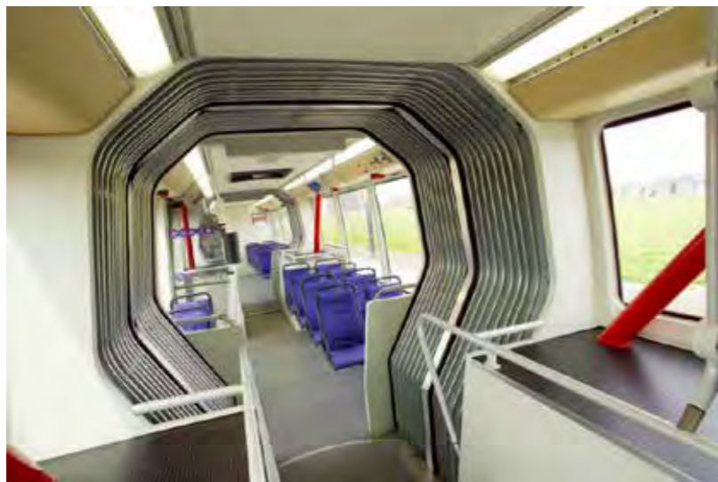
Kuva 95. Superbussissa on raitiovaunun tapaan paljon seisomapaikkoja. Kuvassa 24-metrinen tuplanivelbussi. Kuva: VDL.
