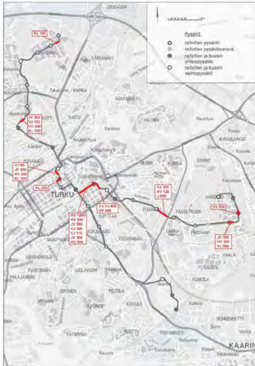
Kuva 69. Katutilan ahtauden vuoksi johtosiirtojen haastavat kohteet.
