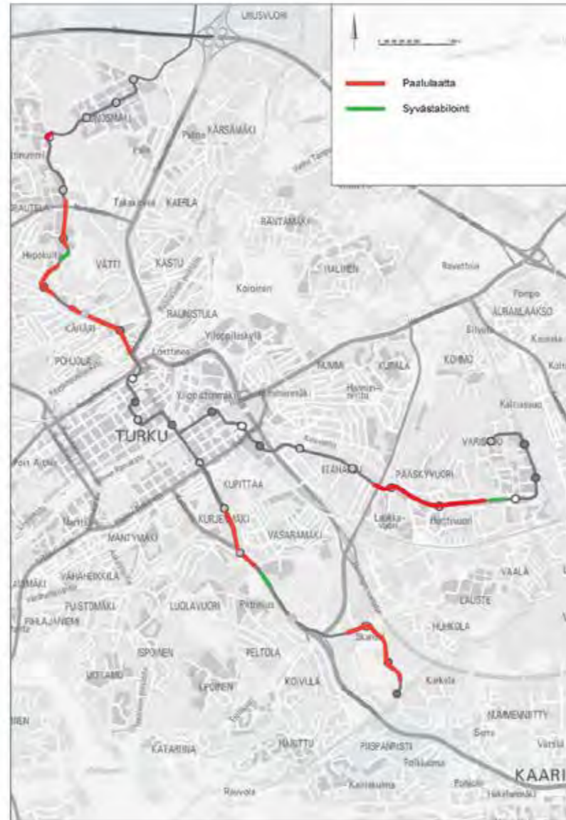
Kuva 67. Raitiotieosuudet, joissa isoimpia maarakennustöitä (paalulaatta tai syvästabilointi).
