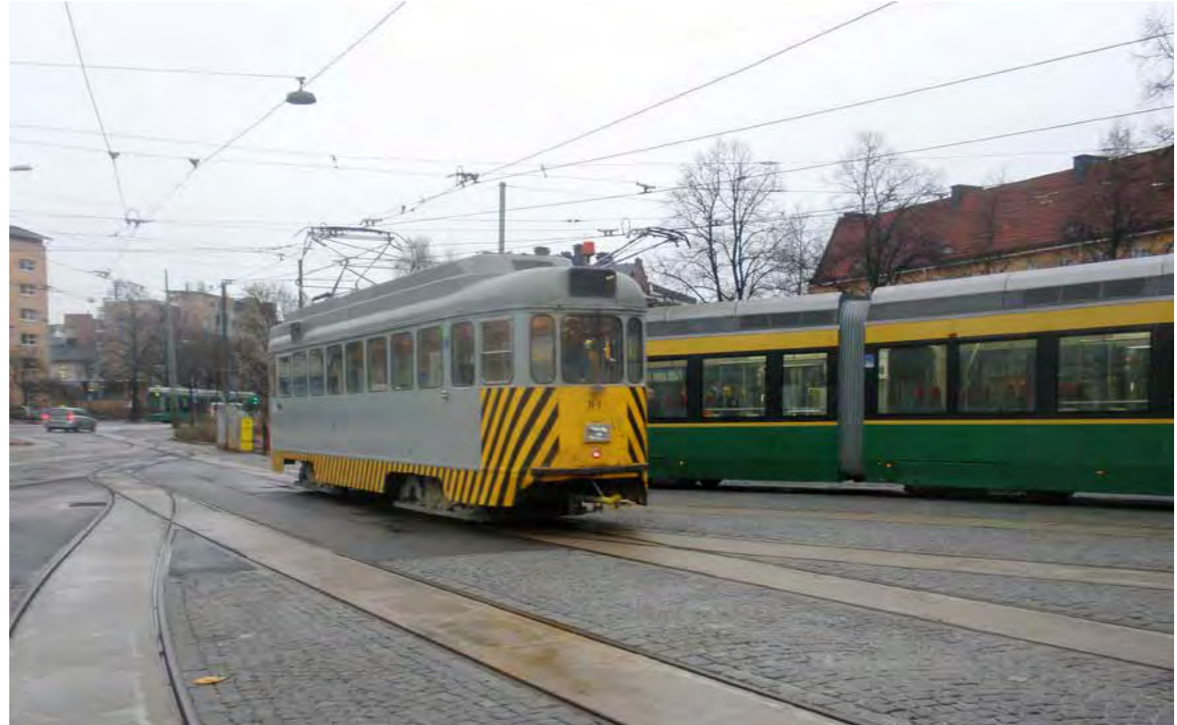
Kuva 72. HKL:n monitoimivaunu. Kuva: WSP
