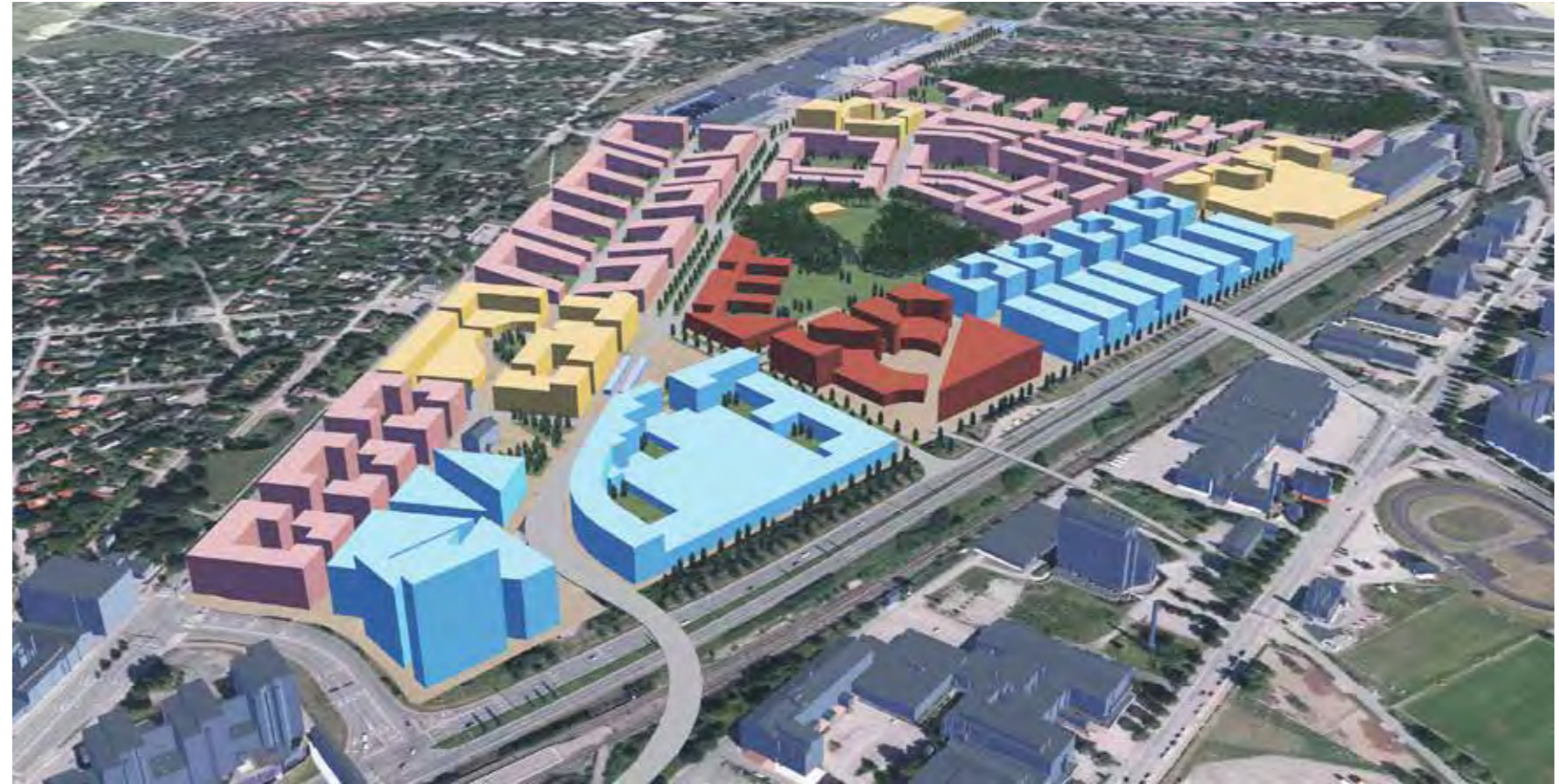
Kuva 84. Raitiotie jatkuu Kupittaan asemalta Helsingintien yli Itäharjuun uutta joukko- ja kevyen liikenteen siltaa pitkin. Kuvassa on osoitettu vaaleanpunaisella asuinrakennukset ja sinisellä toimistorakentamisen kohteet. Keltaisella on merkitty edullisille paikoille sijoittuvat palvelut ja tumman punaisella opetuksen ja tutkimuksen tilat. Kuva: WSP.
