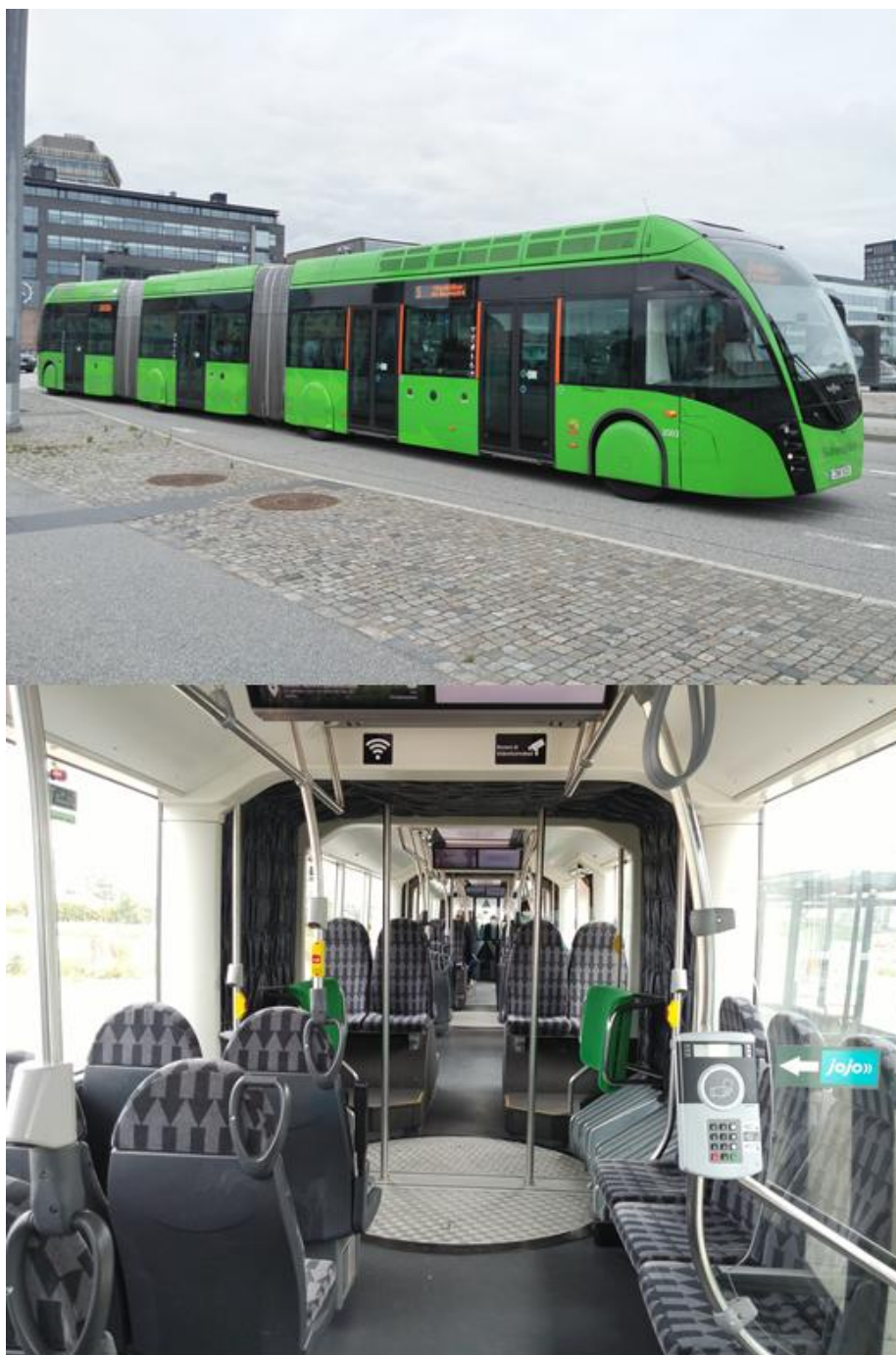
Kuva 20 Malmön BHLS-kalusto 24-metrinen Van Hool ExquiCity kaasu-sähköhybridibussi (Aaltonen 2017).
