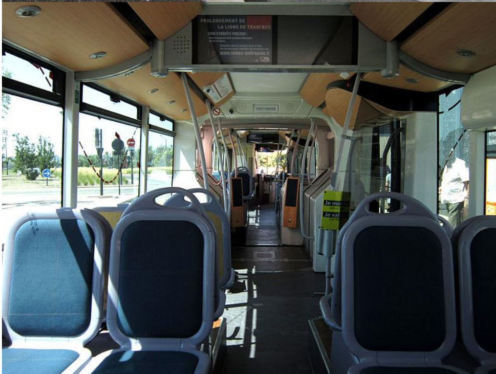
Kuva 14 Nîmes'n BHLS-kalusto Iveco Crealis 18 ulkoa ja sisältä, alakuvassa nähtävissä muun muassa informaationäytöt (Wikimedia Commons 2017).
