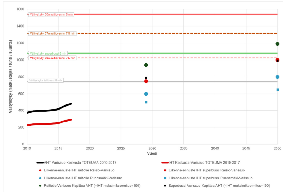
Kuva 3. Raitiotien matkustajaennusteisiin (ympyrät) pystytään vastaamaan matkustusmukavuuden huomioivalla mitoituksella 37-metrillä raitiovaunuilla 7,5 minuutin vuorovälillä. Mikäli valittaisiin 30-metriset raitiovaunut, tulisi aamuhuipputunnin aikana siirtyä viiden minuutin vuoroväliin 2030-luvun lopulla, mikäli aamuhuipputunnin matkustajakuormitus olisi nykytilanteen Varissuo-Kupittaa -välin aamu- ja iltahuipputunnin maksimierotuksen mukaisesti noin 190 matkustajaa/tunti/suunta suurempi kuin iltahuipputunnin aikana. Aamuhuipputunnille ei ole laadittu liikenne-ennustetta.
