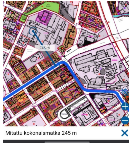
Kuva 9. Pyyhkäisyelektronimikroskoopin ja NMR laitteistojen etäisyys radasta noin 250 m. Lisäksi rata tekee 90 asteen mutkan pois päin mikä pienentää huomattavasti kenttiä verrattuna laskennalliseen arvioon, joka on 250 metrin etäisyydellä alle 15 nT suoralle radalle laskettuna.
