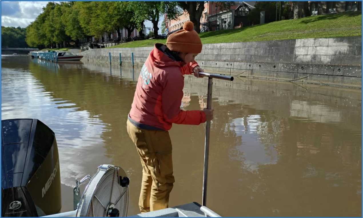
Kuva 8. Aurajoen pohjasta otetaan näytettä venäläisellä suokairalla.
